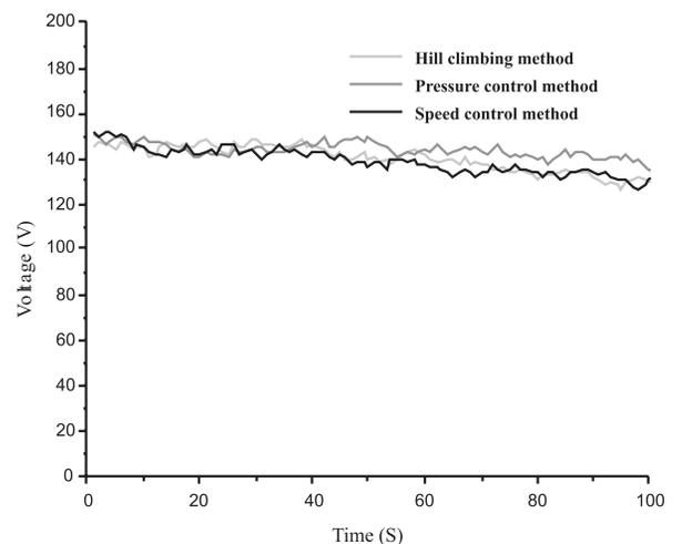
Fig. 7. PV array voltage
